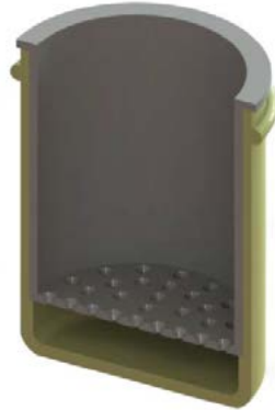
CONTENEDOR DOBLE PARA PROCESO DE DESCELULARIZACIÓN DE FRAGMENTOS Y ESTRUCTURAS ÓSEAS
